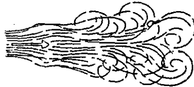
شكل (١) موجات الهواء عند اندفاعها من فتحات الدخول ( سليمان ، ١٩٨٩ ) .
