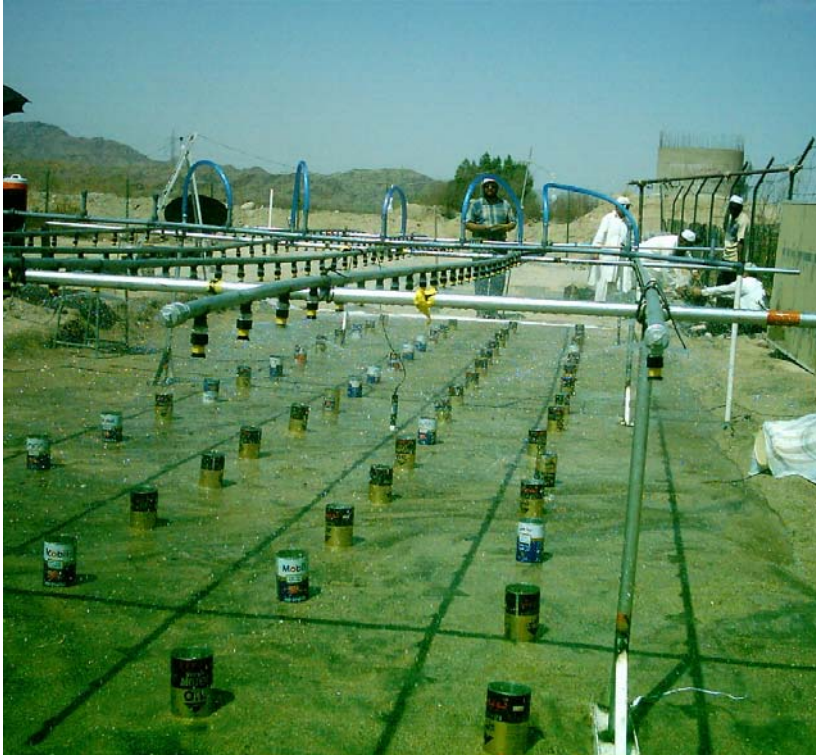
شكل (1): صورة لشبكة تمثيل المطر وتجهيزات التجارب.
