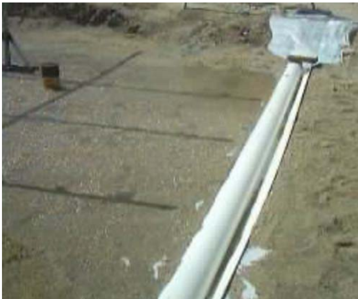
شكل (2): صورة لأنبوب جمع السيل بمخرج موقع التجربة.
